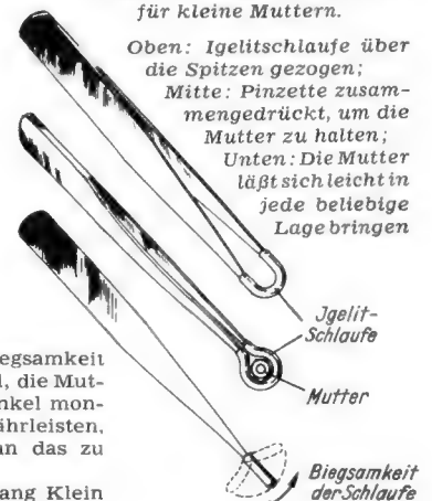
Pinzette als Haltevorrichtung für kleine Muttern.
